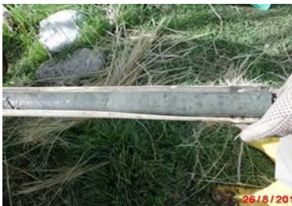
Foto No.3 Bajo la turba se presenta una toba gris verdosa bastante consistente
