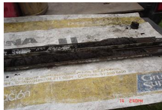
Foto No. 2 Material arcilloso orgánico plástico con alta humedad (turba)
