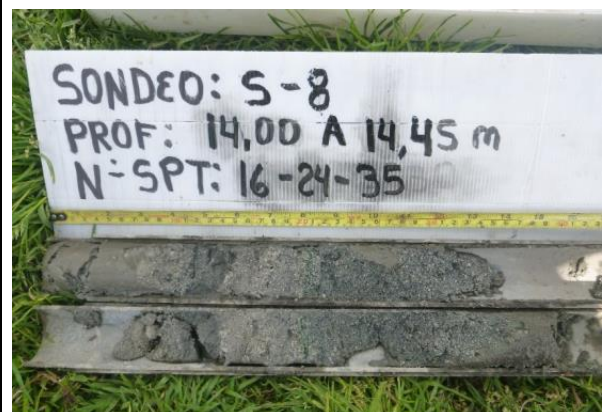
Foto No. 4 Las tobas descansan sobre un material arenoso (posible aluvial)
